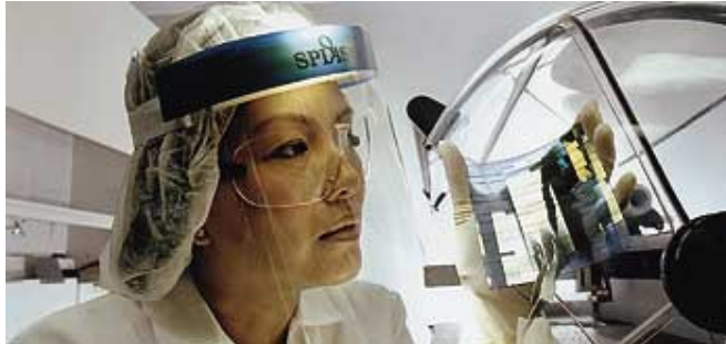
Überprüfung eines Chip Wafers, einer dünnen Halbleiterplatte, bei der Produktion von Chips für die Diagnostik. Foto: Bayer AG
